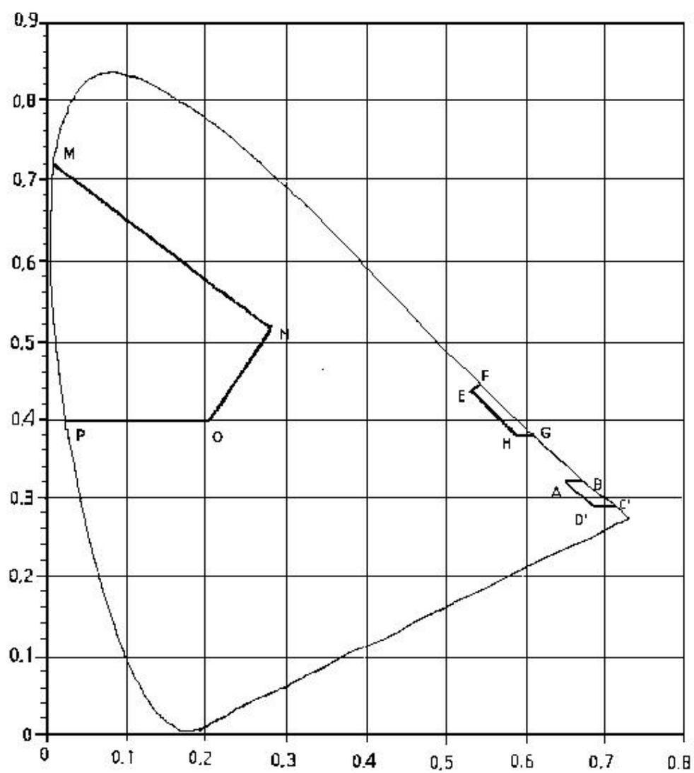
图 B.1 信号灯灯光信号颜色色品图
