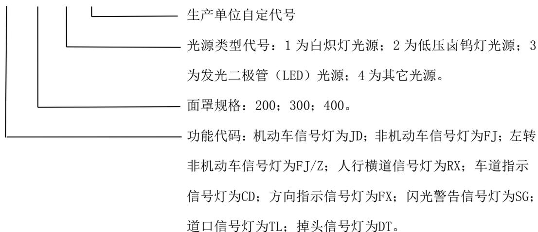
注：太阳能供电信号灯的型号在功能代码前加S，如SJD300-3-XYZ。
